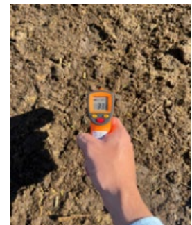
Figura 3 Aferição de temperatura do solo em área após funcionamento da aspersão
