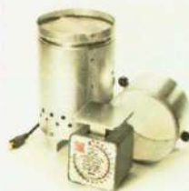
Foto abaixo – Koster (equipamento para a avaliação dos teores de MS dos ingredientes e dietas)
